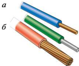
Рис. 11.11. Виды проводов: а — провода с однопроволочными жилами; б — провод с многопроволочной жилой
