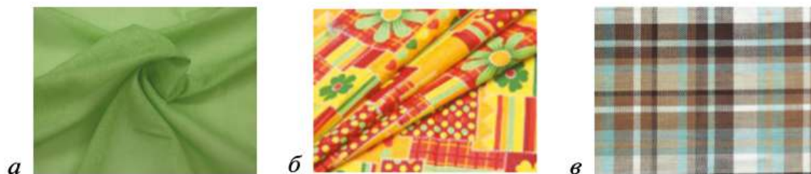
Рис. 6.8. Виды отделки ткани: а — гладкокрашенная ткань; б — печатный рисунок; в — пестротканая ткань
