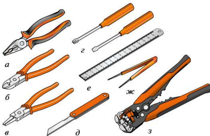
Рис. 11.14. Электромонтажные инструменты: а — пассатижи; б — бокорезы; в — круглогубцы; г — отвёртки; д — нож; е — линейка металлическая; ж — пинцет монтажный; з — приспособление для снятия изоляции с проводов
