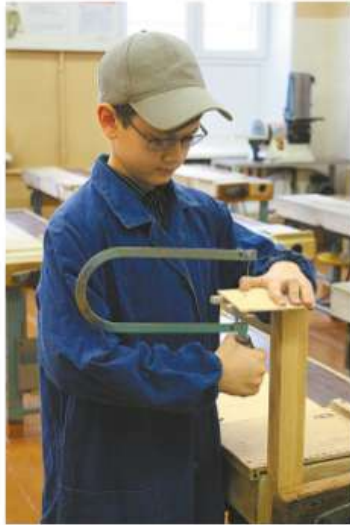
Рис. 8.13. Рабочая поза при выпиливании
