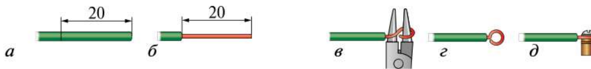
Рис. 11.13. Последовательность выполнения оконцевания провода колечком: а — разметка провода; б — снятие ножом на подкладной доске изоляции; в — свёртывание круглогубцами провода в колечко; г — сборка оконцованного провода
