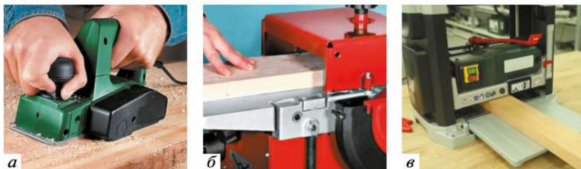
Рис. 4.26. Электрические инструменты и станки для стругания древесины: а — рубанок ручной; б — строгальный станок; в — рейсмусовый станок
