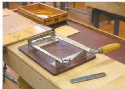
Рис. 8.14. Приспособление для закрепления пилки ручного лобзика
