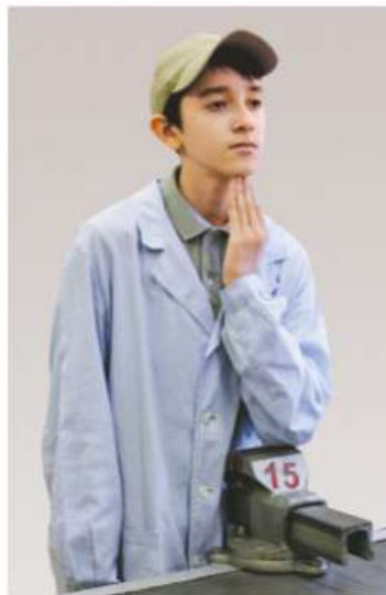
Рис. 5.4. Выбор высоты верстака с тисками в соответствии с ростом ученика
