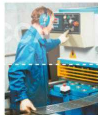
Рис. 5.25. Процесс резки металлического листа на гильотинных ножницах (станке)
