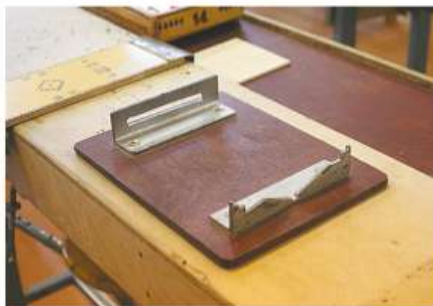
Рис. 8.14. Приспособление для закрепления пилки ручного лобзика
