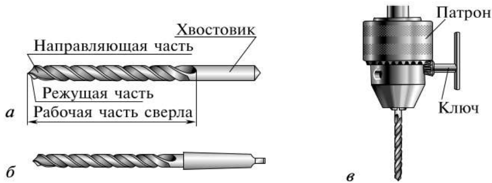
Рис. 5.33. Спиральное сверло: а — с цилиндрическим хвостовиком; б — с коническим хвостовиком; в — в патроне сверлильного станка
