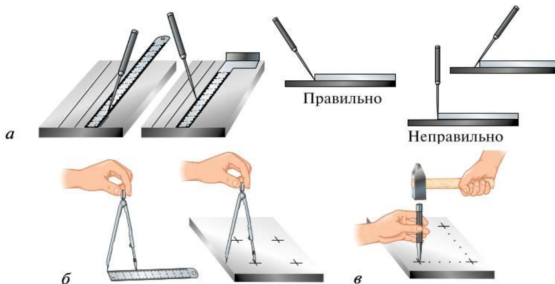
Рис. 5.7. Приёмы разметки: а — прямых линий; б — перенос размеров циркулем; в — накернивание молотком разметочных точек
