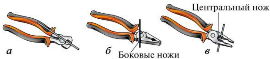
Рис. 5.16. Приёмы откусывания проволоки: а — кусачками; б — боковыми ножами пассатижей; в — центральным ножом пассатижей
