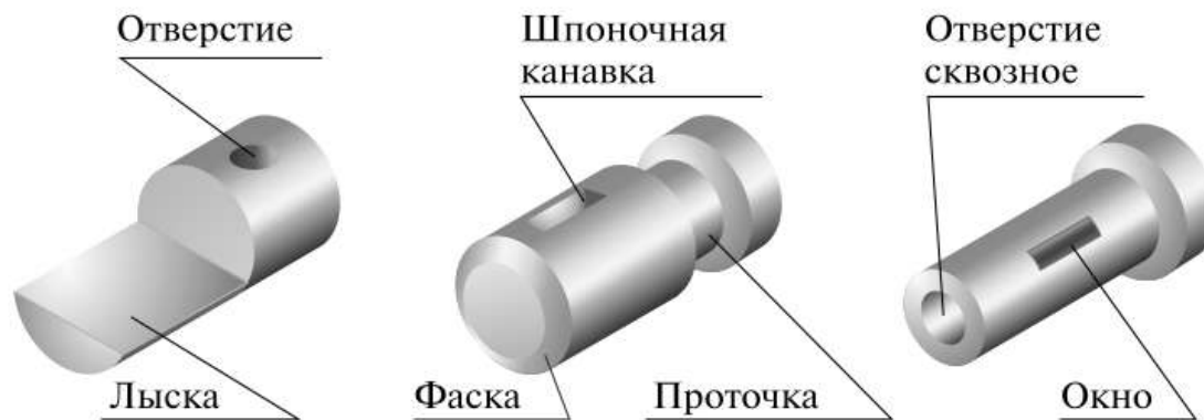
Рис. 3.8. Примеры конструктивных элементов деталей
