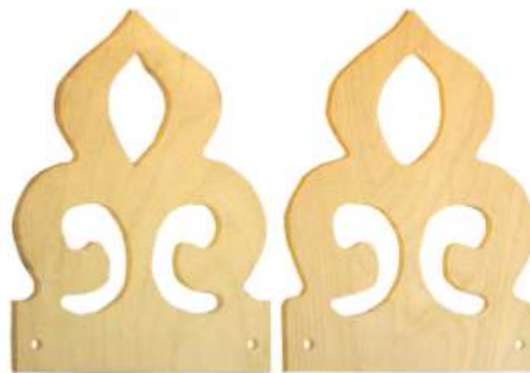
Рис. 8.9. Элементы карниза дома, изготовленные по шаблону
