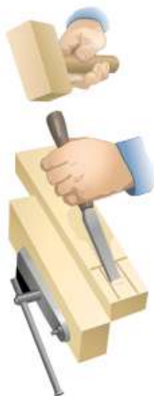
Рис. 4.55. Приём долбления в зажиме верстака
