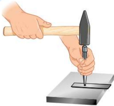
Рис. 5.21. Приём разрубания полосового металла на плите
