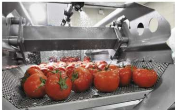
Рис. 7.19. Водная моечная установка для овощей и фруктов
