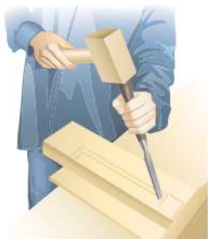
Рис. 4.54. Приём долбления на подкладной доске
