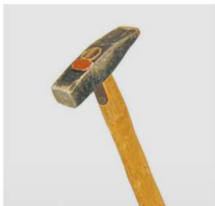
Рис. 5.41. Крепление фиксатора в ручке слесарного молотка
