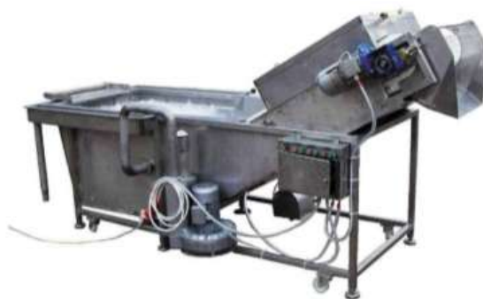
Рис. 7.19. Водная моечная установка для овощей и фруктов
