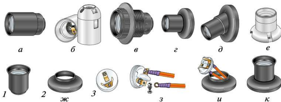
Рис. 11.6. Ламповые патроны, их устройство и подключение: а — подвесной пластмассовый; б — подвесной керамический; в — специальный; г — потолочный; д — настенный; е — настенный керамический; ж — основные части патрона ( 1 — корпус; 2 — основание; 3 — фарфоровый сердечник); з — подключение одного провода, оконцованного колечком, к сердечнику; и — подключение двух проводов к сердечнику; к — потолочный патрон в собранном виде
