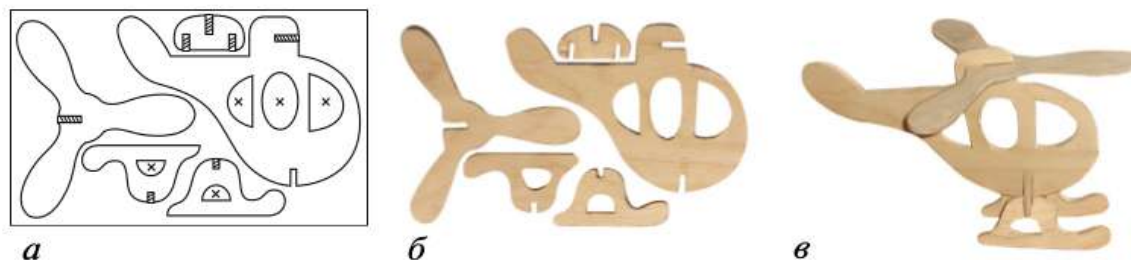
Рис. 3.7. Модель вертолѐта: а — шаблоны деталей на бумаге; б — заготовки деталей из фанеры; в — модель вертолѐта без декоративной отделки
