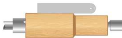
Рис. 4.35. Проверка прямолинейности поверхности заготовки
