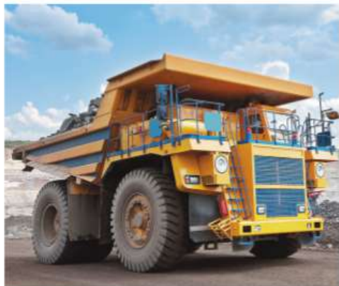
Рис. 3.1. Карьерный самосвал грузоподъёмностью 610 т
