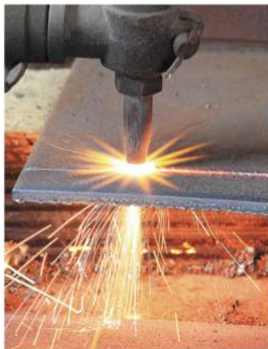
Рис. 2.1. Газовая резка металла
