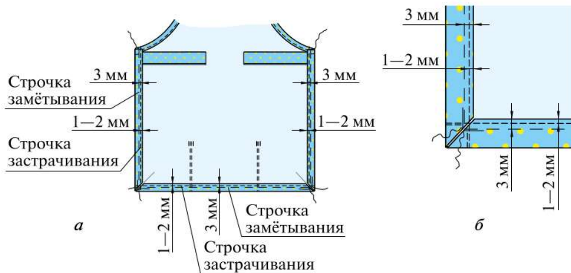
Рис. 6.43. Застрачивание нижнего и боковых срезов нижней части фартука
