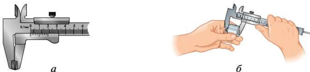
Рис. 5.14. Измерение штангенциркулем: а — проверка исправности; б — измерение
