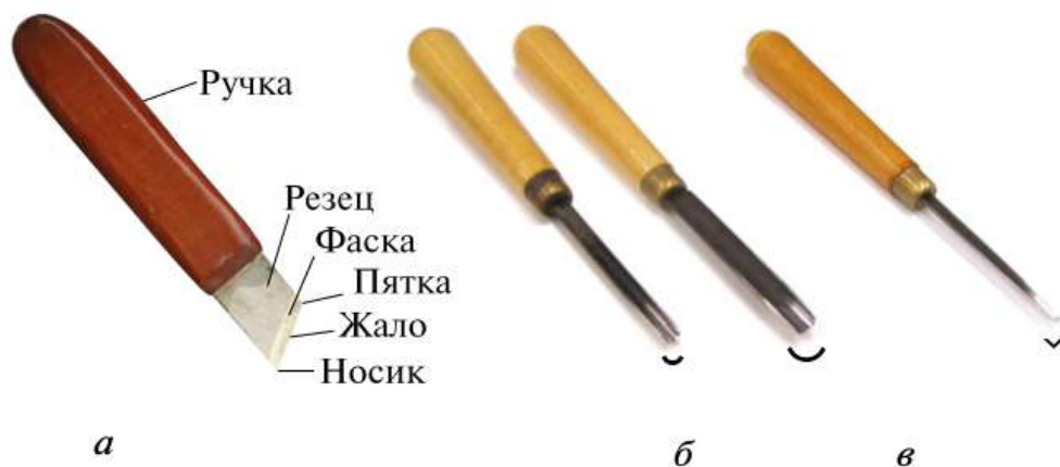
Рис. 8.3. Инструменты для контурной резьбы: а — нож-косяк; б — полукруглые стамески; в — стамеска-уголок
