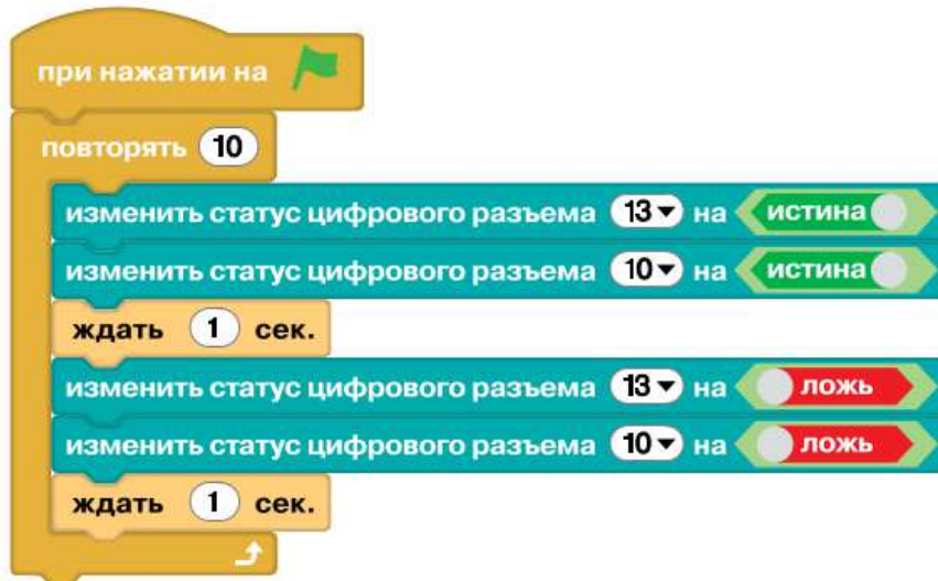
Рис. 10.15. Схема и программа управления двумя светодиодами. Светодиоды мигают синхронно
