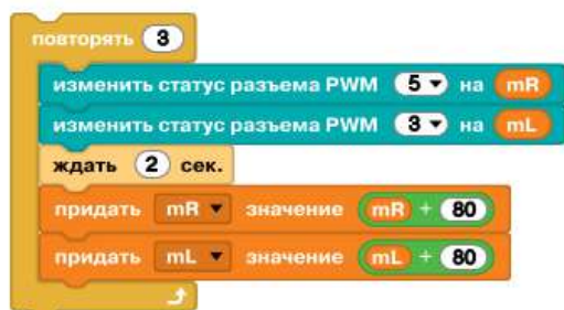
Рис. 10.33. Второй этап программы движения с ускорением — движение со средней, а затем с максимальной скоростью
