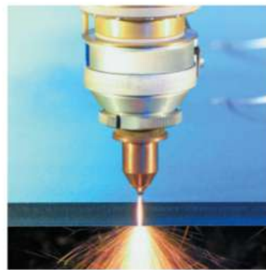
Рис. 2.4. Процесс лазерной резки металлического листа
