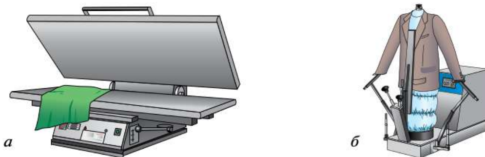
Рис. 4.104. Оборудование для влажно-тепловых работ: а — пресс; б — паровоздушный манекен
