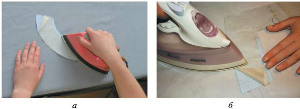
Рис. 4.76. Дублирование обтачек: а — спинки; б — переда
