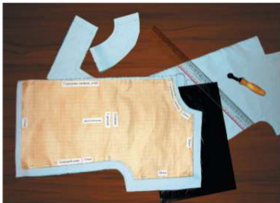
Рис. 4.71. Перевод контуров выкройки: a — инструменты и детали кроя; б — приём работы резцом
