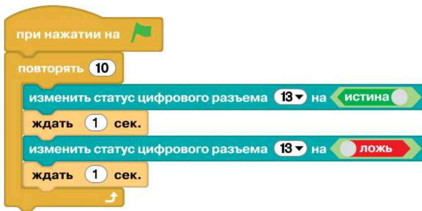
Рис. 10.14. Схема и программа управления одним светодиодом
