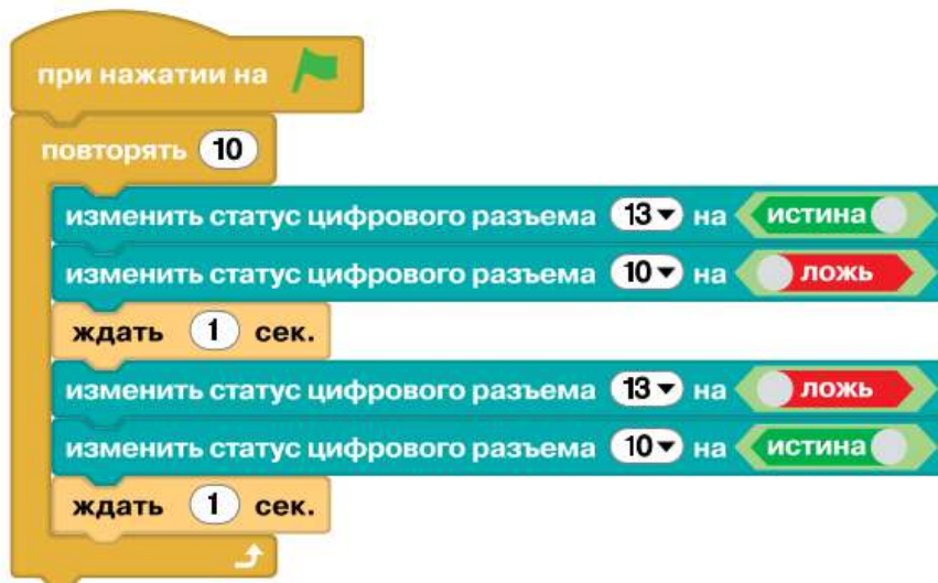
Рис. 10.16. Программа управления линейкой светодиодов. Светодиоды мигают попеременно
