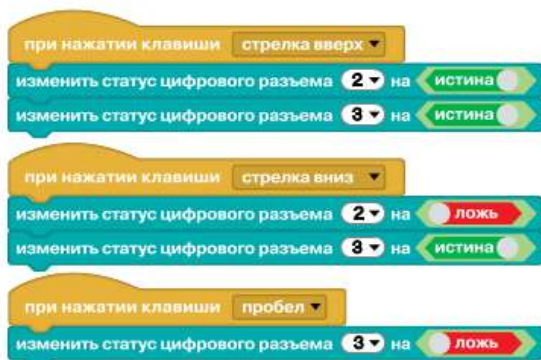
Рис. 10.26. Программа управления направлением вращения мотора
