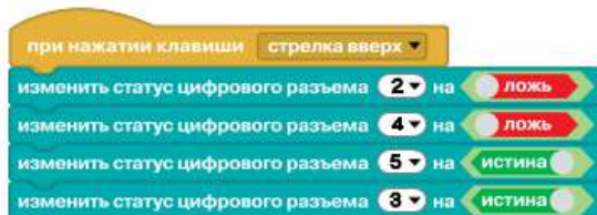
Рис. 10.28. Программа прямолинейного движения робота
